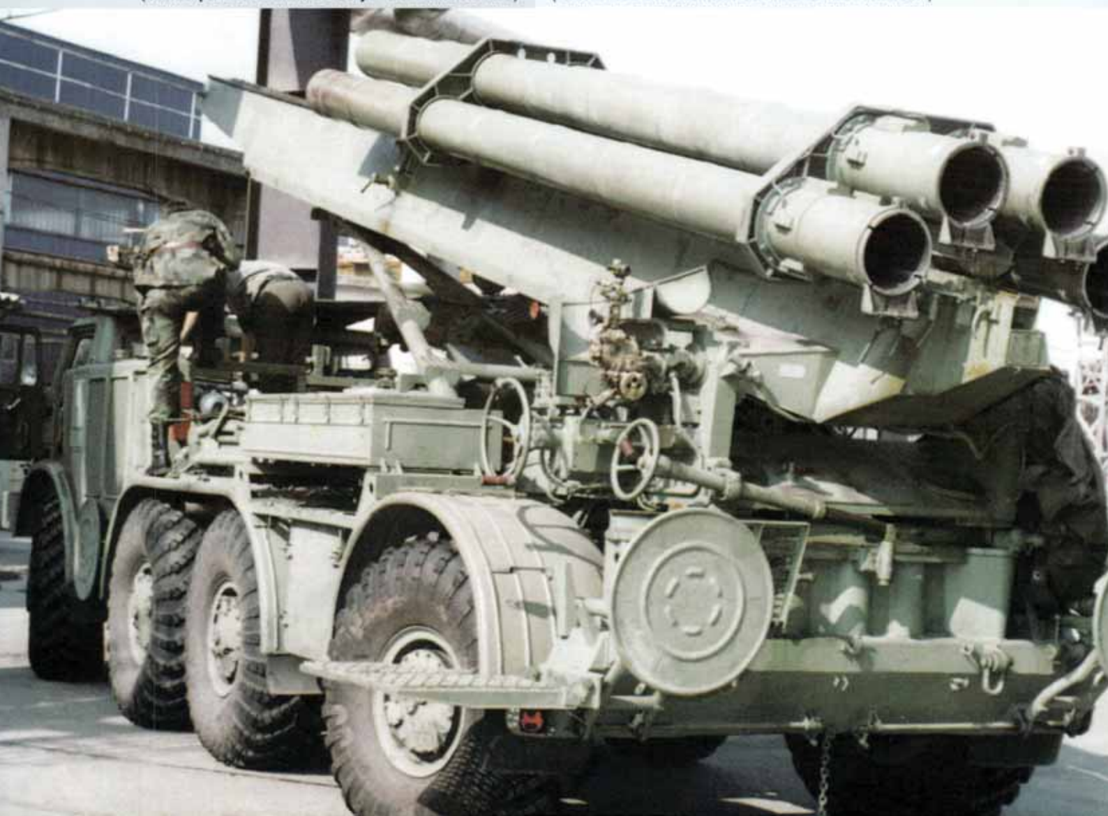
Четвороцевни лансер ракета 262 мм - успешан спој два сложена система (лансера ОРКАН и шасије система ЛУНА)
