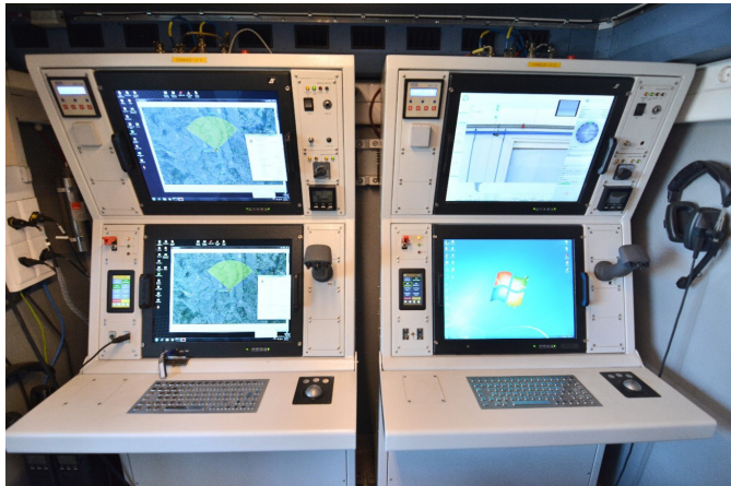
Двухконсольный тип НСУ, установленный в кузове-контейнере с возможностью размещения на прицепе или в кузове автомобиля
