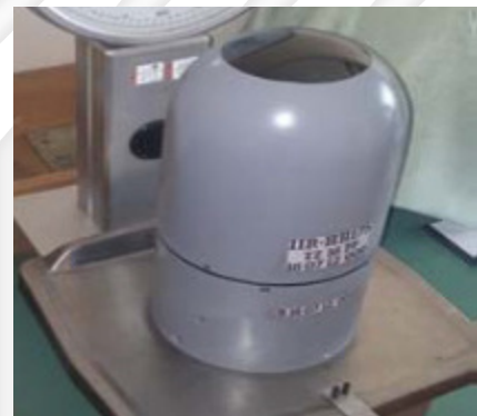
Тепловизионная ГСН IIR HH 145 mm
