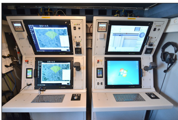
Dve konzole kontrolne stanice u kabini, koja može da se smesti na prikolicu ili montira na vozilo
