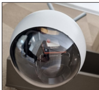
Televizijska glava za samonavođenje TV/IIR HH 145 mm
