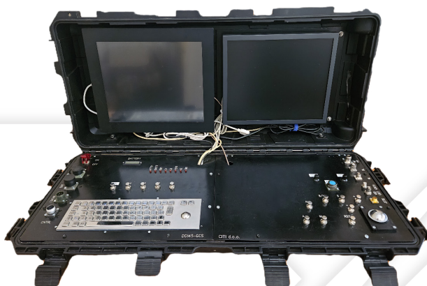
Prenosna zemaljska kontrolna stanica
