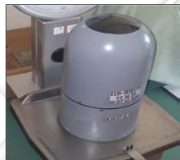
Termovizijska glava za samonavođenje IIR HH 145 mm
