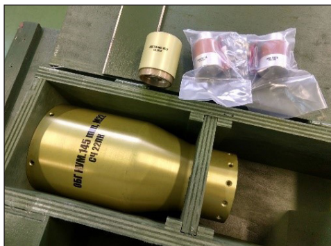
Противотанковая, тандемно-кумулятивная 145 мм, 6.4 кг, TSCWH, с вспомогательной БЧ и взрывателями
