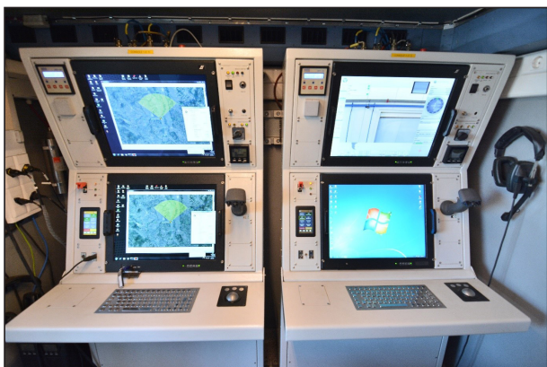
Две панели кабинной станции управления, с возможностью размещения на прицепе или в корпусе, установленном на платформе машины
