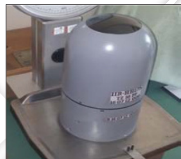
Termovizijska glava za samonavođenje IIR HH 145 mm
