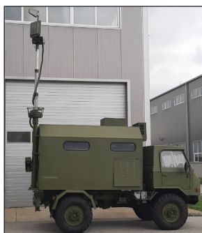
Kontrolna stanica sa antenskim sistemom
